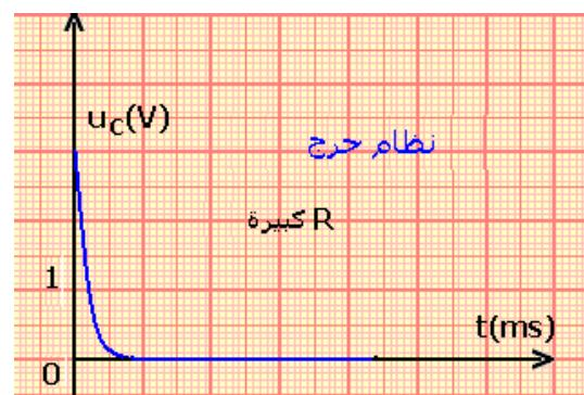
في الذبذبات الحرجة توجد قيمة معينة للمقاومة نرمز لها بـ  $R_C$  وتسمى مقاومة حرجية وهي مقاومة تفصل بين النظام شبه الدوري والنظام اللا دوري ونسمي النظام في هذه الحالة بالنظام الحرج وفي هذه الحالة يرجع التوتر  $u_C(t)$  إلى صفر بسرعة دون تذبذب وتنطبق  $R_C$  بـ  $C$  و  $L$ .
